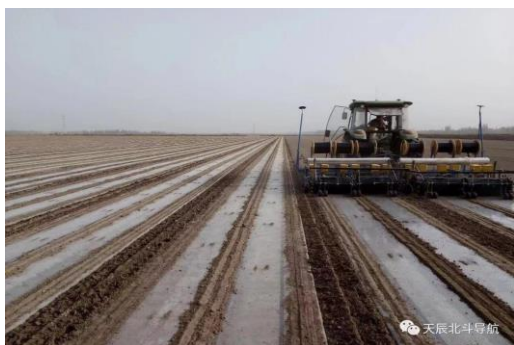
图 2-28 孙飞驾驶北斗导航农机 自动驾驶系统在田间工作
